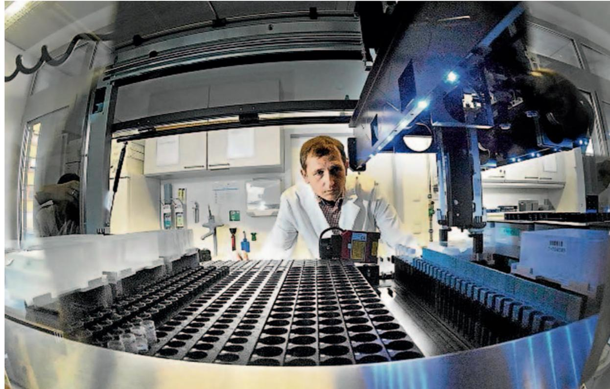
Der Mensch hinter der Maschine: Laborleiter Dr. Kaimo Hirv setzt bei der Typisierung potenzieller Stammzellspender auf Roboter. Dieser hier holt in nur zwei Stunden die Erbsubstanz DNA aus 96 Blutproben. FOTOS (3): KLAUS HAAG
