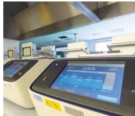
Die Thermocycler führen die Temperaturzyklen einer Polymerase-Kettenreaktion (PCR) selbstständig durch
